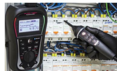
Una **calamita** nella parte posteriore consente di posizionare lo strumento in qualsiasi parte del quadro elettrico.
