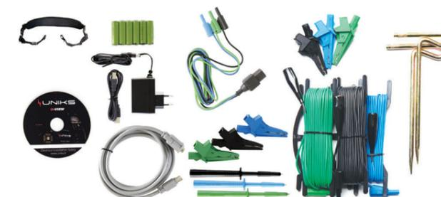
Grazie al **set di terra incluso** è possibile eseguire anche la **misura di terra** con il metodo Voltamperometrico.
