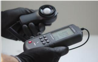
E300 garantisce condizioni di luce ottimali, misura la luce da lampade a LED a luce bianca, fluorescente, ioduri metallici, sodio ad alta pressione e fonti ad incandescenza.
