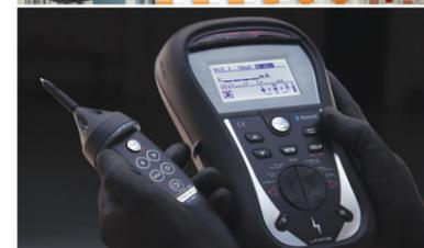
I comodi **puntali remoti** opzionali A1314 (a punta) o A1401 (con shuko ) permettono di muoversi liberamente, avviare o terminare le prove e settare lo strumento.
