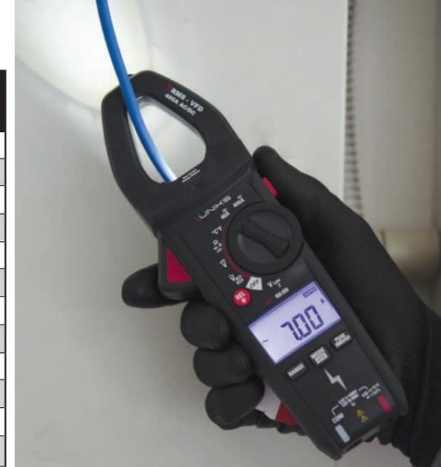
Le pinze amperometriche **C54** e **C58** sono dotate di **Display** retroilluminato con **4000 punti di misura**.
